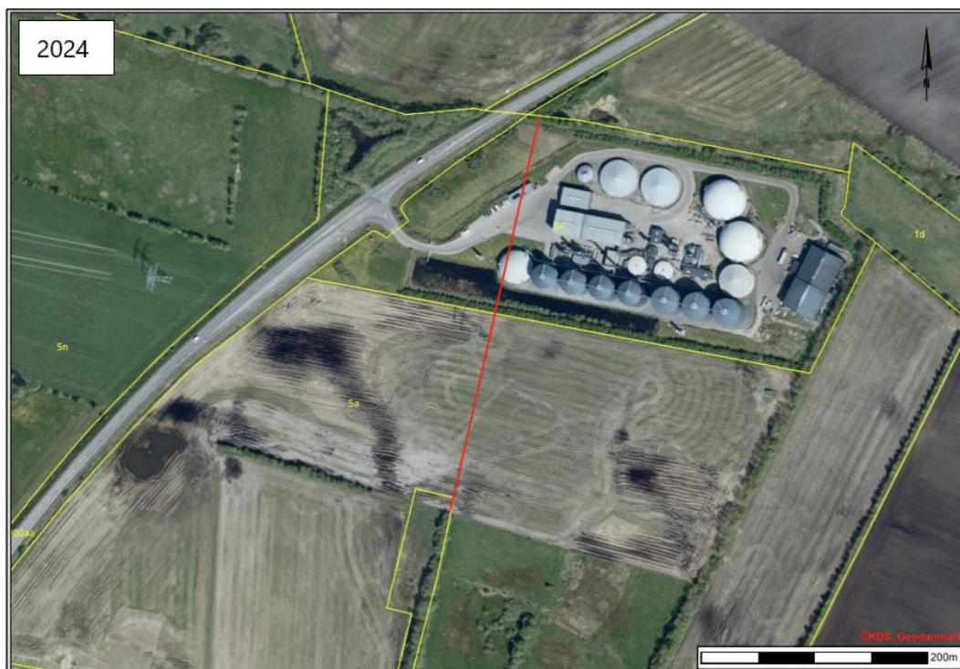
Figur 1: Forløb af vandløb på matrikel 5a Nr. Holsted By, Holsted og 5x Nr. Holsted By, Holsted. Øverst ses åbent forløb på 1995-luftfoto. Nederst ses 2024-luftfoto, hvor vandløbstracé er markeret med rød linje. De gule streger angiver matrikelskel. Målestok er angivet i nederste højre hjørne. Baggrundskort © SDFI, 25.06.2025/WMS-tjeneste, Ortofoto forår 2023 og forår 1995, matrikelskel. Indeholder data, som benyttes i henhold til vilkår for brug af danske offentlige data.
